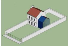
implantation des panneaux solaires sur toiture et façade d'une extension neuve Surface des capteurs limitée à 1/3 de la surface de la surface de
